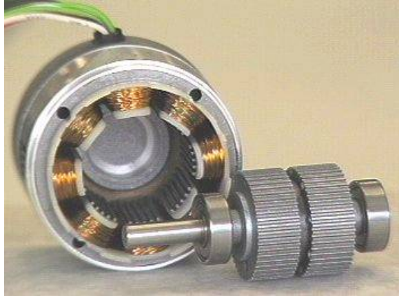
Figur 2: Hybridmotor, till vänster stator med lindningar, till höger rotor med tänder. [13]
